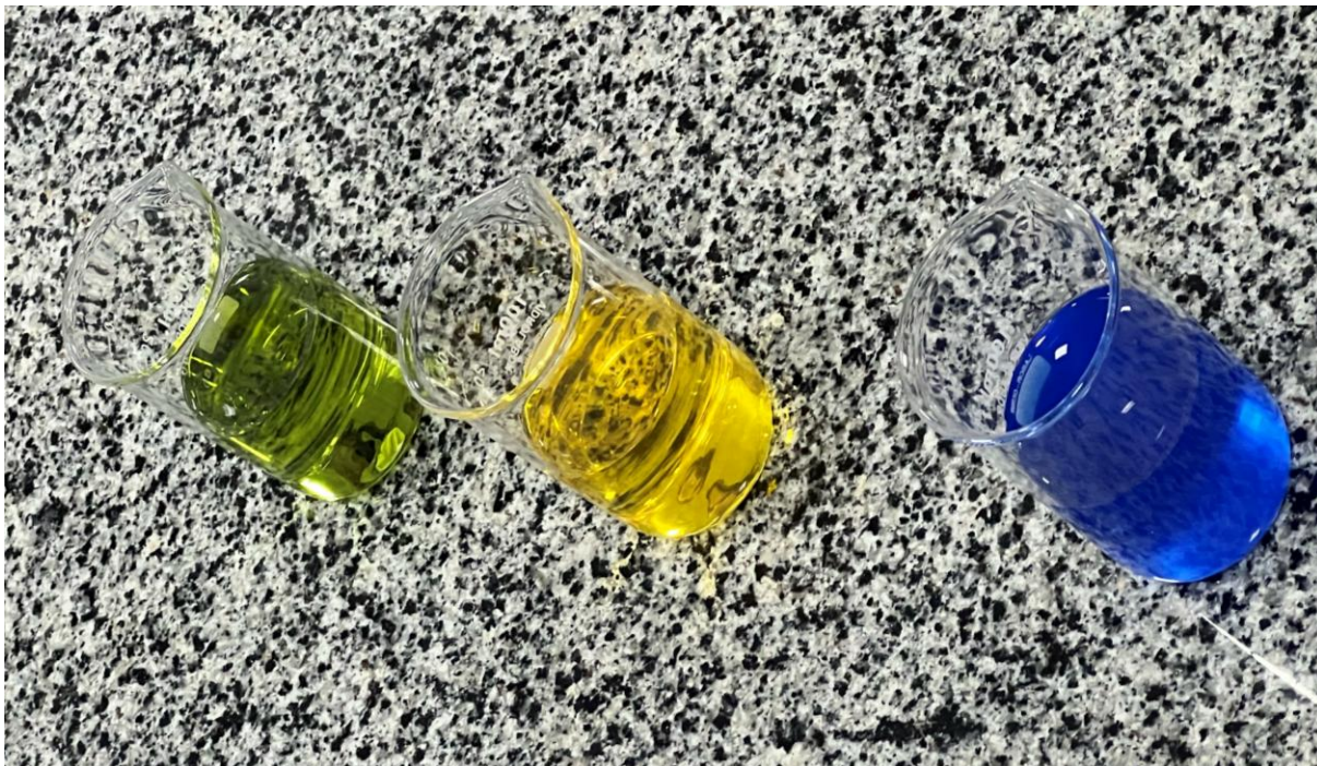
Figura 2. Béqueres em meio neutro, ácido e básico, respectivamente adicionado Azul de Bromotimol
